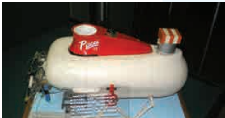
«Пайсис» – подводный аппарат для глубинных исследований. Первое погружение проведено на Байкале в 1977 году на глубину 1410 м
